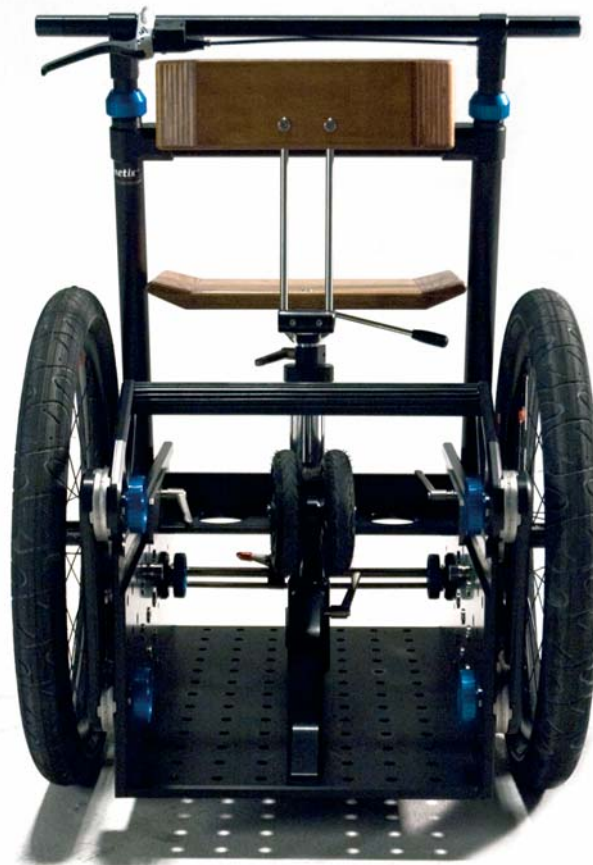
Transportkonfiguration: 3. Rad - Up Side Down - vorne in dem Body befestigt
